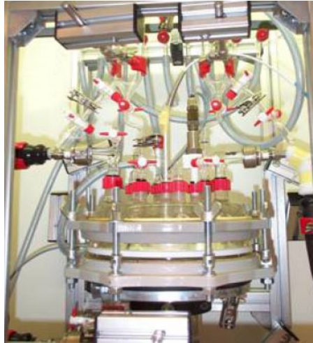
<그림 3-2>. Glass type Bunsen 반응기 장치 (Anzieu et al., 2005).
