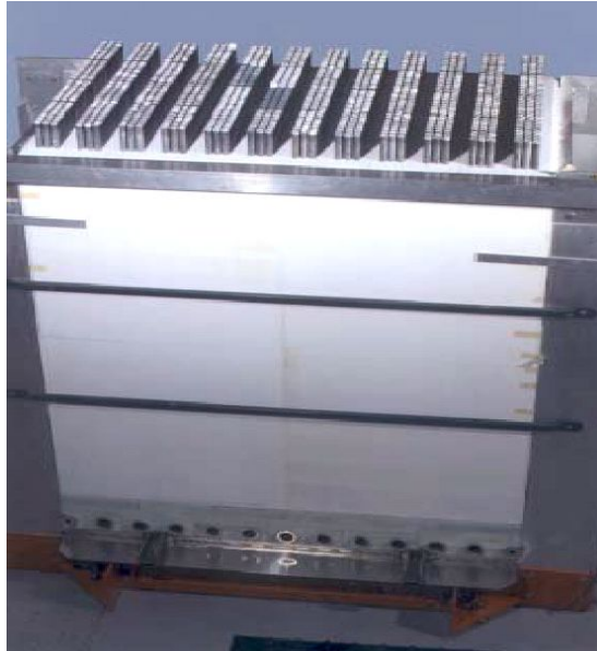
그림. 9. 48개의 번들로 구성된 100W급 전력시스템의 스택사진(지멘스-웨스팅하우스사)
