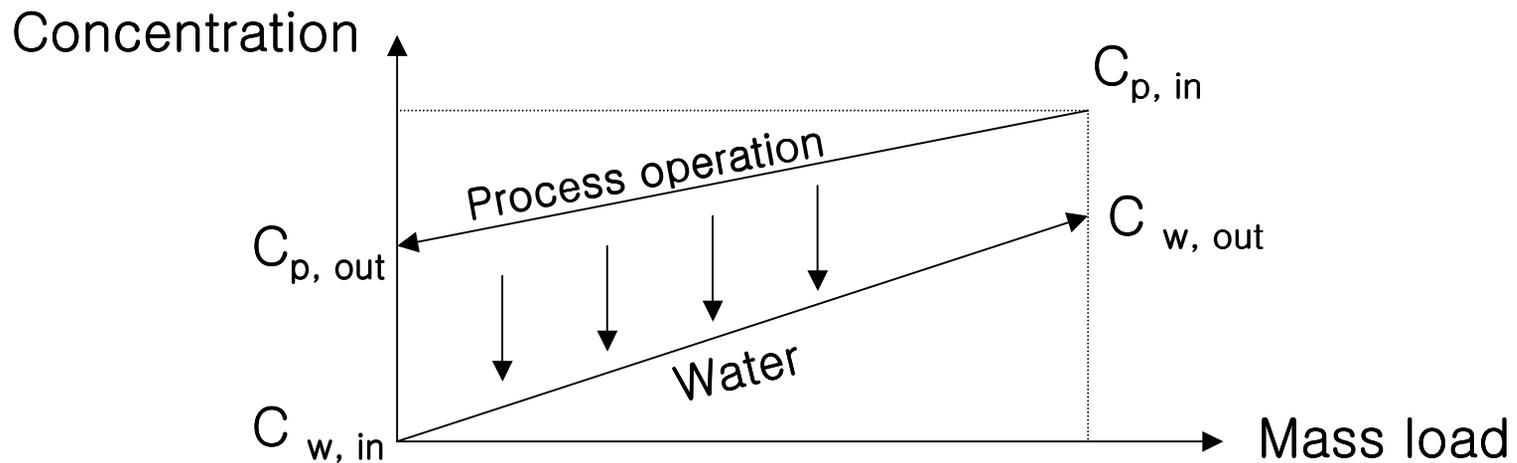
※공정에 사용되는 Water 의 inlet 과 outlet 의 농도와 전달되는 오염물의 양을 비교하여 Water의 flow rate 를 나타내고 있다.
