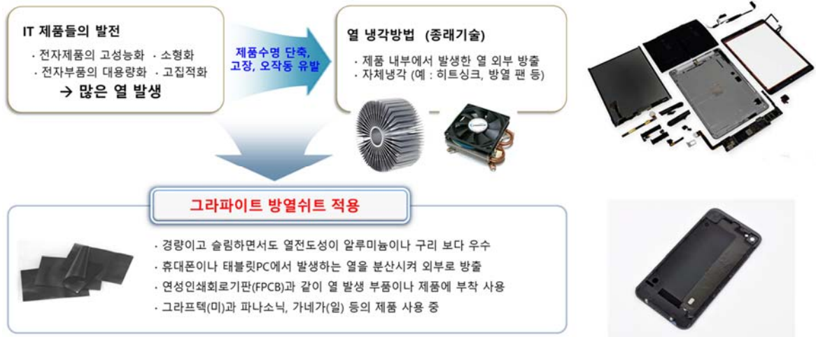
그림 1. 그래파이트 시트 기반 고방열 필름의 필요성 및 실제 전자소자 적용 예
