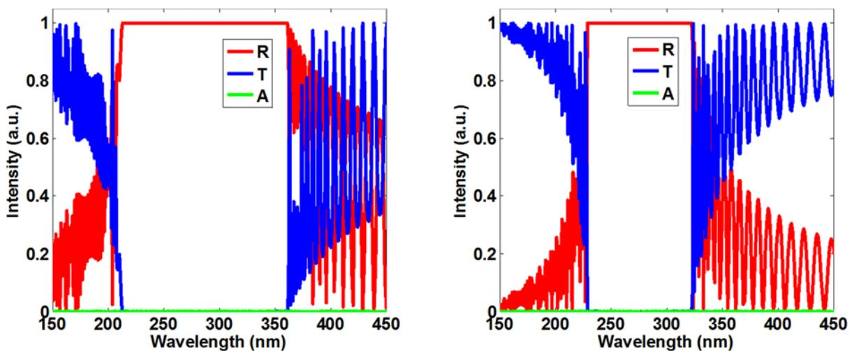
그림 4.1. TMM-SMM으로 계산된 DBR (1D PhC,  $M = 50$ ) 다층 박막 구조의 반사, 투과, 흡광도. (좌) TE 모드, (우) TM 모드로 편광된 빛이  $45^\circ$ 의 입사각으로 다층 구조에 입사한 경우
