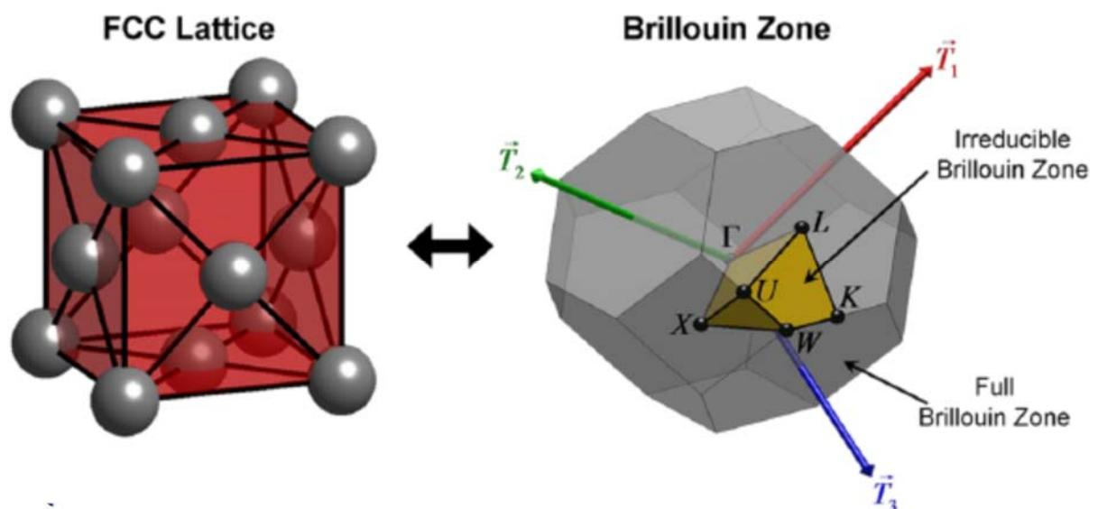
그림 4.7. FCC 구조의 격자 (왼쪽)과 이에 대응하는 브릴루앙 영역 (오른쪽 회색 다면체), 그리고 그의 IBZ (irreducible Brillouin zone, 노란색 다면체)
