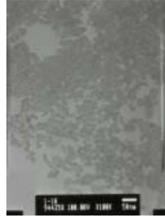
Fig. 2 SiO<sub>2</sub> 나노입자의 TEM 사진 (암모니아 1wt%, 나노입자 5wt%)
