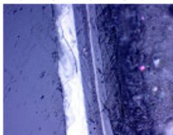
**Fig. 4** 시료2는 G사 커피 포장재로 총 6개 막으로 구성된 Film의 단면 촬영 사진, 각각 도막두께는 1)36.90 $\mu$ m, 2)19.98 $\mu$ m, 3)6.60 $\mu$ m, 4)14.04 $\mu$ m, 5)21.25 $\mu$ m, 6)53.95 $\mu$ m,  $\times$  200
