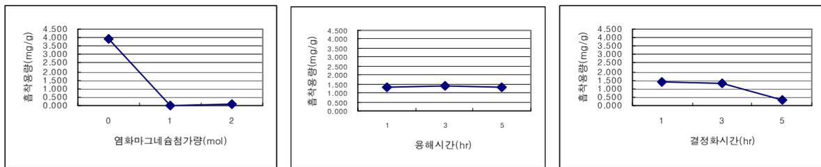
석탄재로부터 제조한 흡착제의 질소(N) 흡착능력은, 석탄재의 용해시간과 결정화 시간에는 크게 변하지 않는 것으로 나타났다. 그러나 석탄재를 2.0M NaOH 용액으로 처리 시에 MgCl<sub>2</sub>를 혼합하여 처리하면 질소의 흡착 능력이 거의 상실되는 것으로 나타났다.
