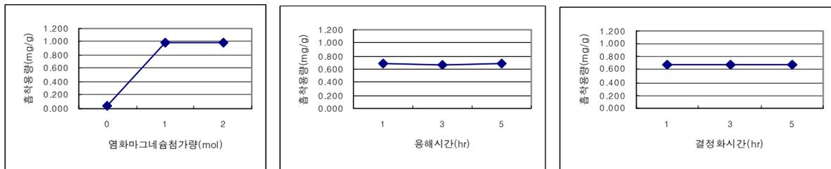
석탄재로부터 제조한 흡착제의 인(P) 흡착능력 또한 석탄재의 용해시간과 결정화 시간에는 크게 변하지 않는 것으로 나타났다. 그러나 석탄재를 2.0M NaOH 용액으로 처리 시에 MgCl<sub>2</sub>를 혼합하여 처리하면 P의 제거능력이 크게 향상되며, MgCl<sub>2</sub>의 첨가농도는 1.0M 이하면 충분한 것으로 나타났다.
