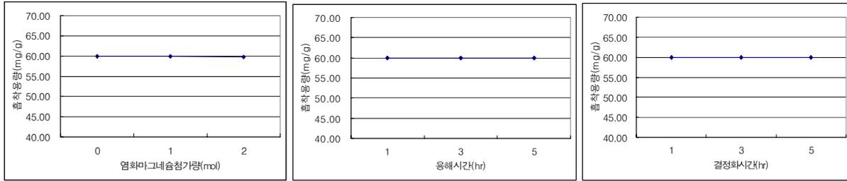
석탄재로부터 제조한 흡착제의 메틸렌블루 흡착 능력은, 석탄재를 2N NaOH 용액으로 처리 시에  $MgCl_2$ 를 혼합 처리함에 따라서 변화가 없는 것으로 나타났다.
