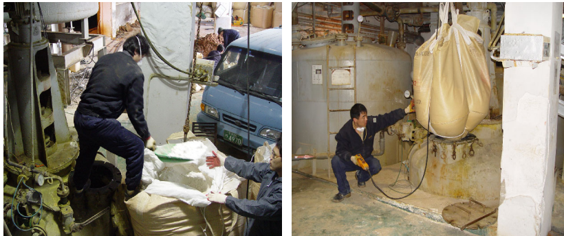
Fig. 1 개발장비 설치전 공정에서의 원료 공급 모습
