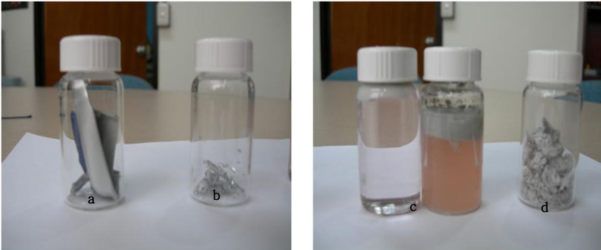
Fig. 3 폐 PC/ABS 시료; a) 핸드폰 본체(PC/ABS ), b) 여과물-coating층 금속 코팅물질, c) PC/ABS 상 분리, d) PC/ABS 회수고형물.
