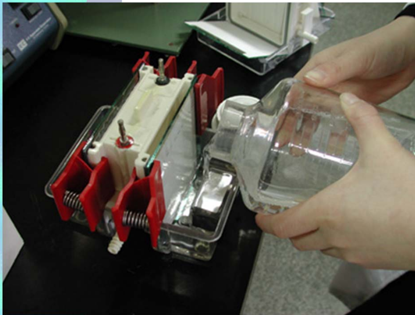
Fig.14. Running buffer로 빈 공간 채우기.
