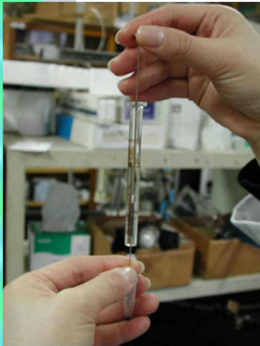
Fig.15. Micro syringe로 각 lane에 sample 주입.
