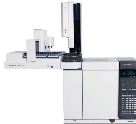
Autosampler가 장착된 GC (*autosampler: 시료들을 자동으로 순서대로 주입해주는 장치)
