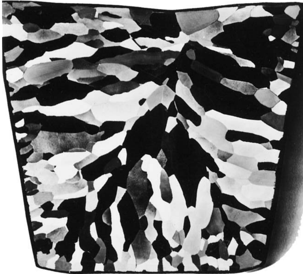
Fig. 5.17 결정립계를 보여주는 고순도의 다결정 lead ingot (납 덩이) 사진.
