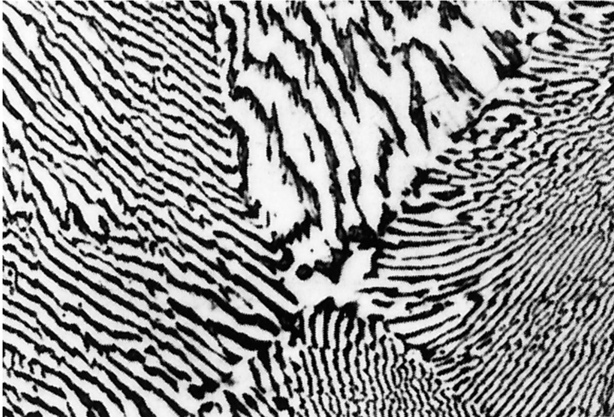
Fig. 10.14 Pb-Sn 계의 공용조성에서의 미세구조 현미경 사진: 밝은 층 ( $\alpha$ 상 고용체)과 어두운 층( $\beta$ 상 고용체)이 교대로 반복되는 구조.
