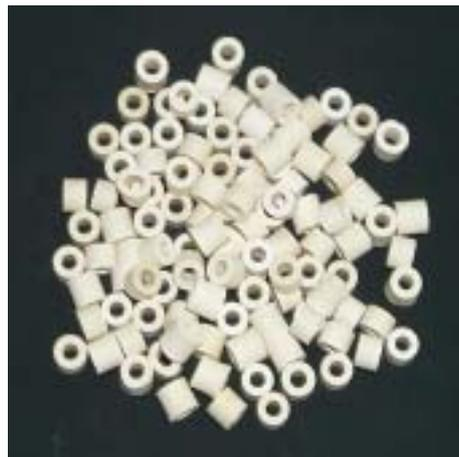
[그림 6-7] 1/4" 스테인리스 라쉬링과 K/MgO 촉매
